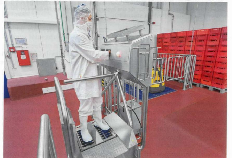
Die Personal-Hygieneschleuse ermöglicht das hygienische Reinigen der Schuhsohlen und das Reinigen sowie Desinfizieren der Hände.
