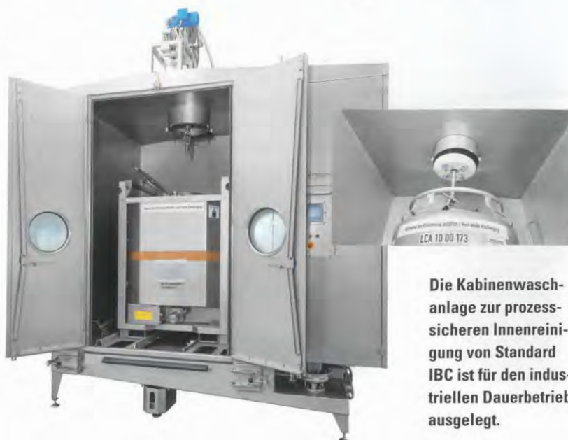
Die Kabinenwaschanlage zur prozesssicheren Innenreinigung von IBC-Rundcontainern ist für den industriellen Dauerbetrieb ausgelegt.
