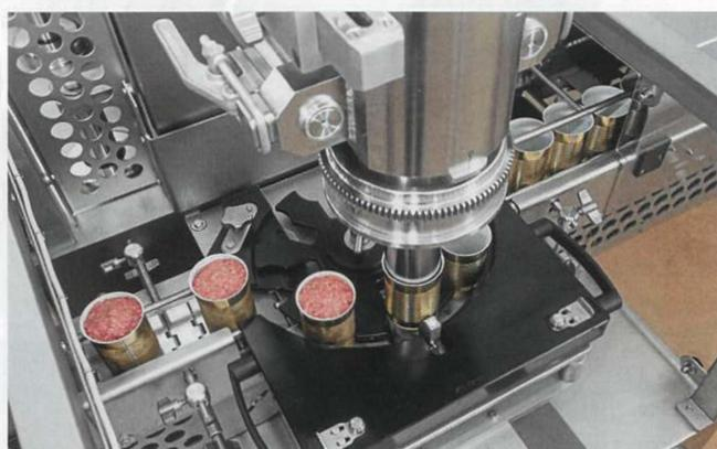
Mit der Dosen- und Gläserfüllanlage FKF607 lassen sich pastöse, fließfähige oder stückige Massen sauber, exakt und schonend abfüllen.
