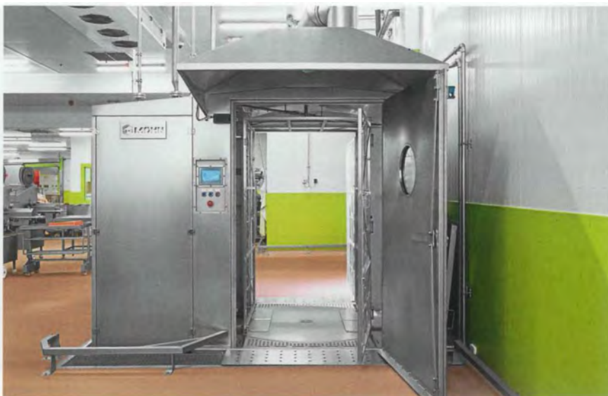
Das 2-Türen-Prinzip ermöglicht bei der Selchwagen-Waschanlage eine Zonentrennung in Rein- und Unreinbereich.
