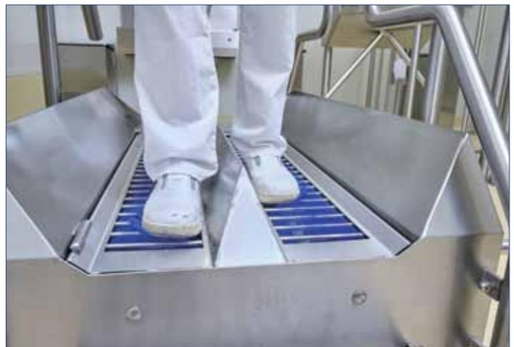
Innovative Sohlenreinigung mit patentierter Federtopftechnik spart Energie: Die Bürstenwalzen werden erst beim Betreten des Lauf-Rostes aktiviert.
