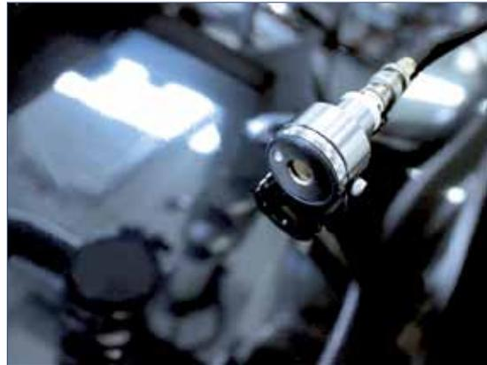
Innovativ: eine schwingquarz-basierte Sensorlösung für die Inline-Reinigungsüberwachung in geschlossenen Systemen.
