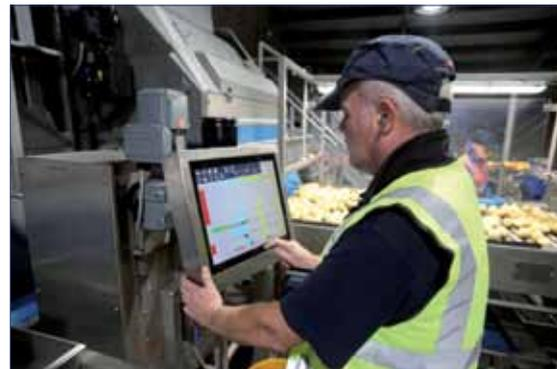
Das Gerät identifiziert und entfernt auf Wunsch Kartoffeln mit Krankheiten und Defekten sowie Kartoffeln außerhalb des angegebenen Längen- und Breitenprofils.
