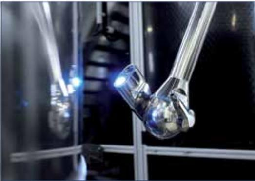
„AJCsens“ – ein Novum für die Tankreinigung: Inline-Monitoring durch hochintegrierte Verschmutzungssensorik in adaptivem Zielstrahlreiniger. Fotos: Fraunhofer IVV
