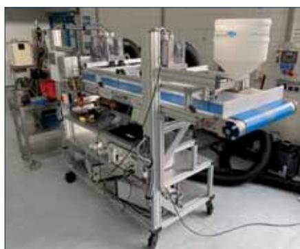
Das Förderband ist etwa drei Meter lang und wiegt mehrere hundert Kilogramm.
