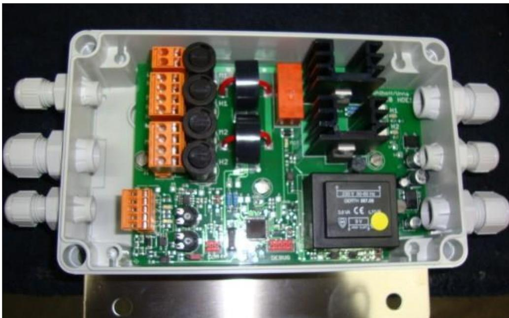
Wasserdichtes Gehäuse mit der eingebauten Steuerung HDE-10
