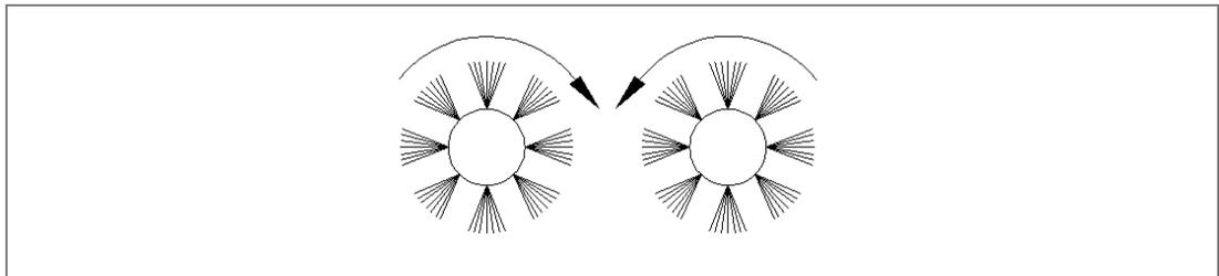
Abb. 8: – Laufrichtung der Bürsten bei korrektem Drehsinn
