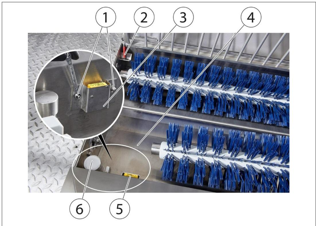
Abb. 16: – Laufgitter geöffnet mit einer ausgebauten Bürste
