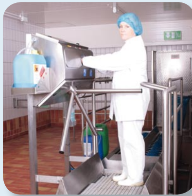
Handdesinfektion mit Vollkegelstrahldüsen für großflächige Verteilung
