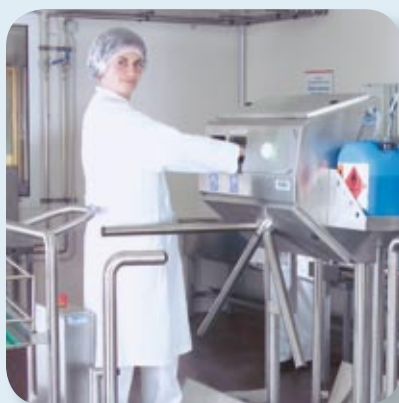
Handdesinfektion mit Vollkegelstrahldüsen für großflächige Verteilung
