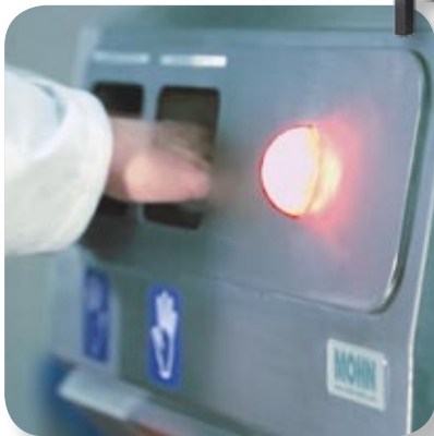
Handdesinfektion mit überlistungs-sicheren Sensoren
